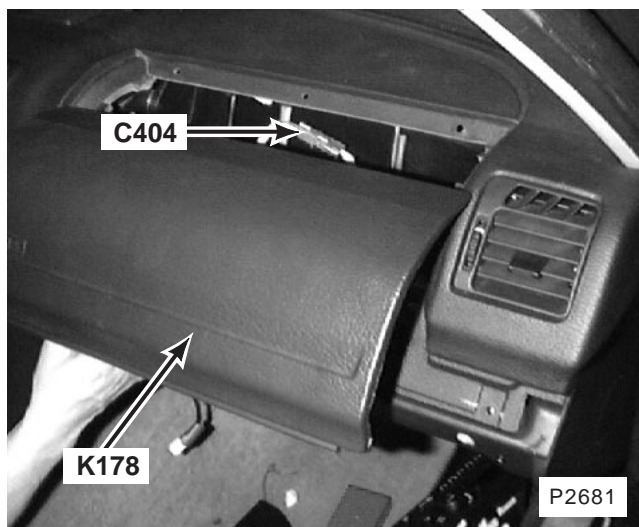
85. parte superior del cuadro de instrumentos, lado del acompañante K178 Airbag del acompañante C404 (2-R)
