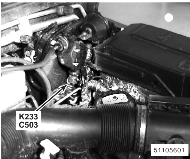
280. compartimiento del motor, parte trasera izquierda K233 Válvula de bloqueo de la ventilación del depósito de carbón activado C503 (2-R)
