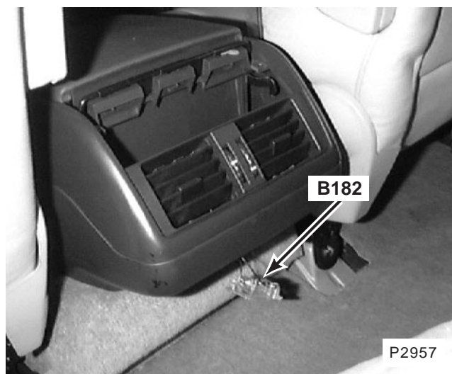
203. en la consola central detrás de B182 Luz hueco para los pies, atrás
